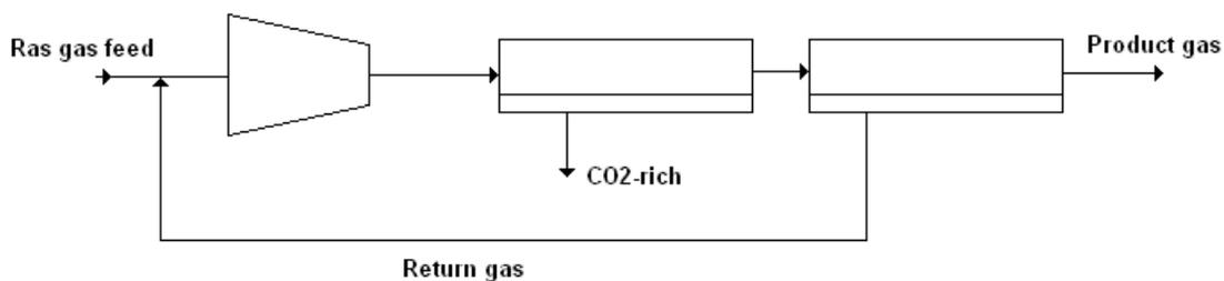
FIGURE 7: COMMON DOUBLE STAGE MEMBRANE CONFIGURATION
